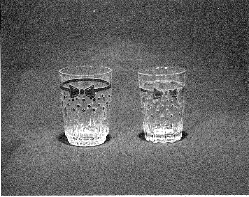
Resim 2) Soldaki bardak işlem görmemiş dayanıksız boya Sağdaki bardak DIN 51035 standardı uygulanmış dayanıksız boya
