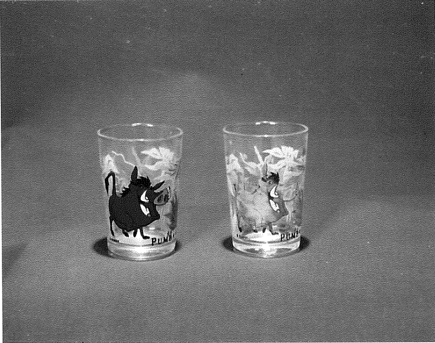
Resim 3) Soldaki bardak işlem görmemiş dayanıksız boya Sağdaki bardak ASTM-C 676-88 uygulanmış dayanıksız boya
